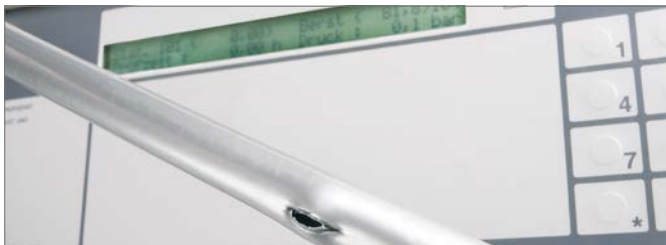
Abb. 3-1 Ergebnis einer Berstdruckprüfung mit dem Universalrohr RAUTITAN flex
