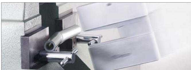
Abb. 3-2 Universalrohr RAUTITAN flex im Kerbschlag-Prüfgerät
