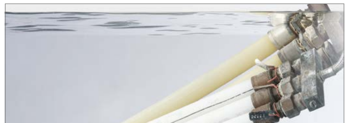
Abb. 3-4 Rohre im Langzeittest (unter Druck im Wasserbecken)
