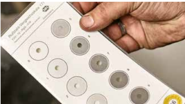
Keine Schwarz-Weiß-Malerei... auf die Nuancen kommt es an: Anhand der vorgegebenen Farbskala lässt sich die Rußzahl ermitteln. (Bild: Wöhler)
