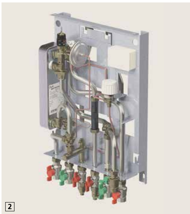
2 Die „EvoFlat Reno“-Wohnungsstationen (hier dargestellt ohne Rohr-Wärmedämmung) weisen einen hohen Vormontagegrad auf, der dem Installateur eine Vielzahl typischer Arbeitsschritte erspart.
