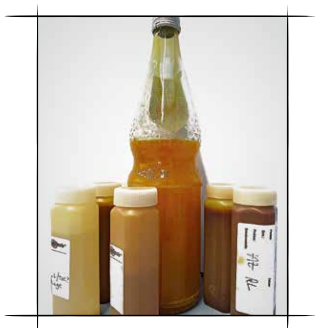
1 Proben von Heizungswasser, wie sie im Labor-Alltag des Öfteren vorkommen. Häufig sind die Heizungswässer unmittelbar bei der Probenahme nur leicht gefärbt, bei Sauerstoffzutritt fallen dann 3-wertige Eisenkorrosionsprodukte aus. (Abbildungen: perma-trade Wassertechnik)
